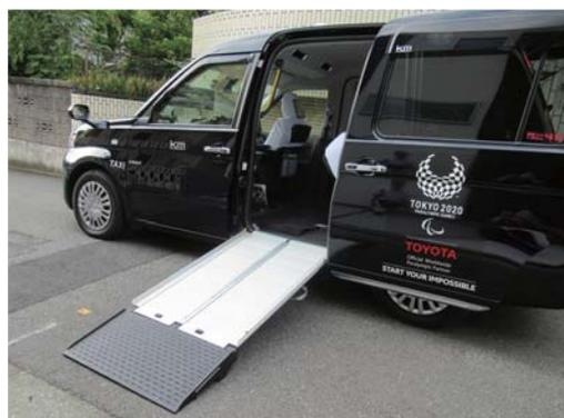
ジャパンタクシーは車体の横にスロープを渡して車イスを乗せるので、道路の横幅が必要になります。まず車幅約1.7m、スロープ約1.3m、車イスの乗り込みスペース約1mなので、乗り降りに必要な道幅が4mは必要です。一般的な住宅街では車がぎりぎりすれ違える4m程度の道路が多いので、ジャパンタクシーの乗り降りできる場所は限定されます。
